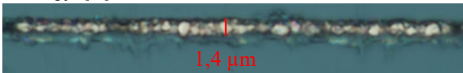
37 pav. Siauriausias SSAIL technologija suformuotas vario takelis ant PET polimero naudojant Gauso pluoštą
