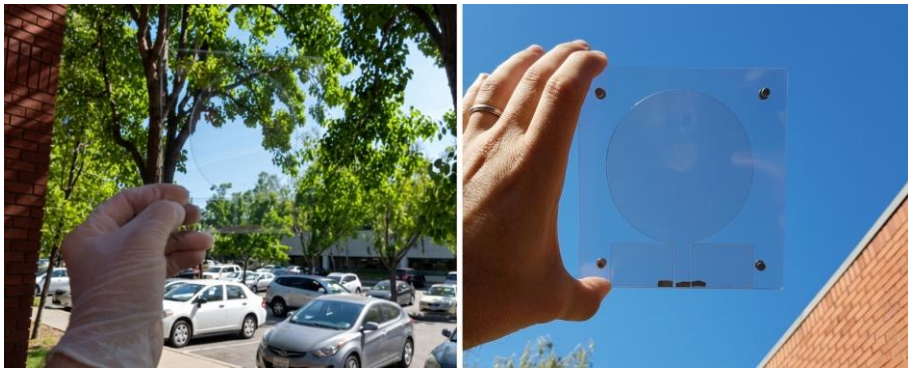
4 pav. Skaidri lanksti „nematoma“ antena [54]
